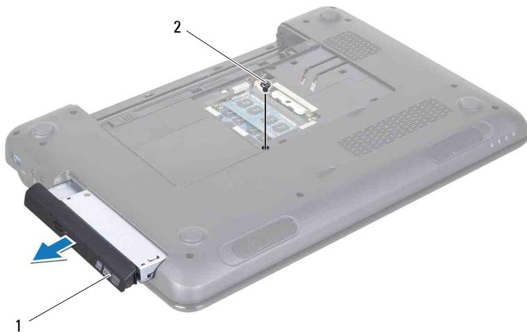
1 Ensamblaje de la unidad óptica      2 Tornillo
